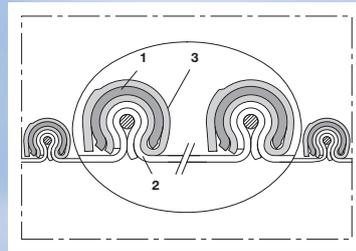
排废气软管; 抗振动, 外部保护, 非常有韧性(耐废气温度达+300 °C\*)
