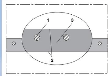
食品及药品工业用抗静电抽吸及输送软管(FDA); PUR < 10<sup>9</sup> Ω 不锈钢加强筋, 超重型, 内外壁平滑
