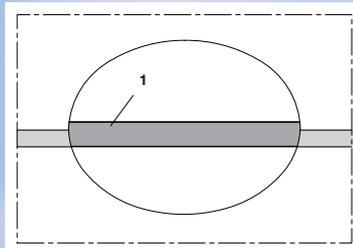
**耐磨损耐压软管; 无加强软管, 内外壁平滑**
